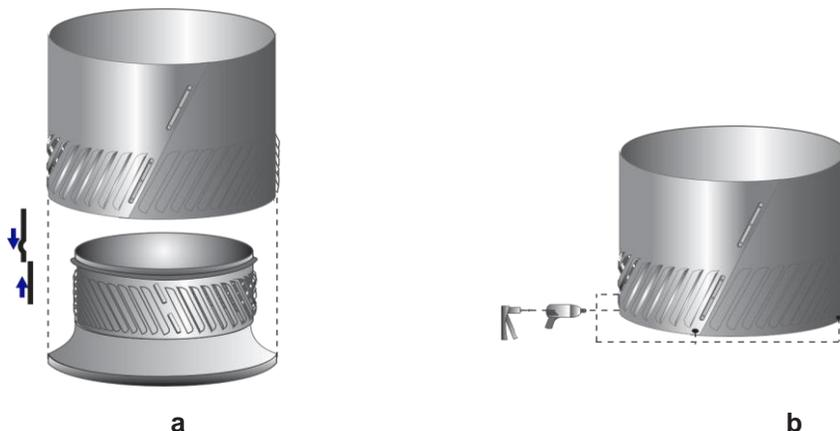
Encaixar a veneziana externa no conjunto interno (montado) (fig. 4a), furar e rebitar ambas *(veneziana externa e conjunto interno)* em 6 (seis) pontos equidistantes com broca 4mm (fig. 4b). *Ao fabricante reserva-se o direito de realizar modificações sem prévio aviso.*
